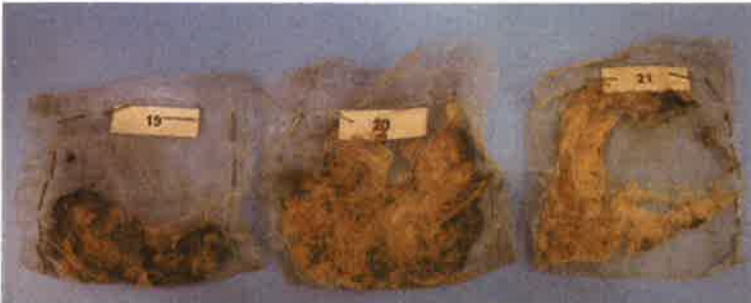
3020 nach 6 Tagen Erdlagerung
