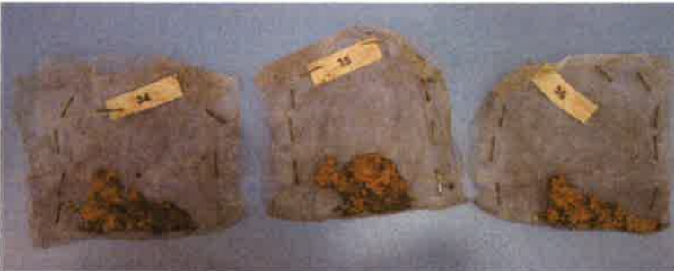
3020 nach 41 Tagen Erdlagerung
