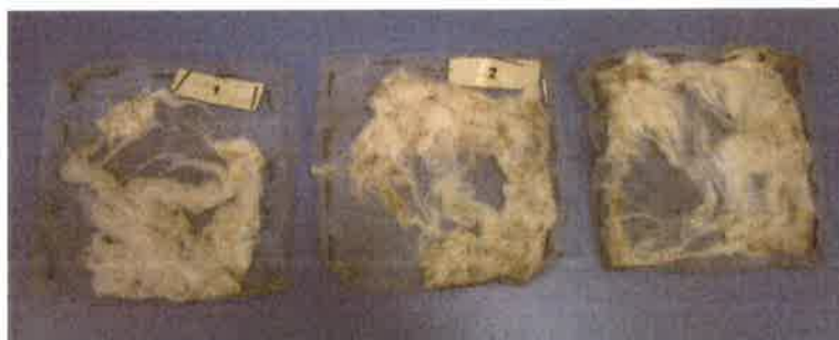
3019 nach 6 Tagen Erdlagerung
