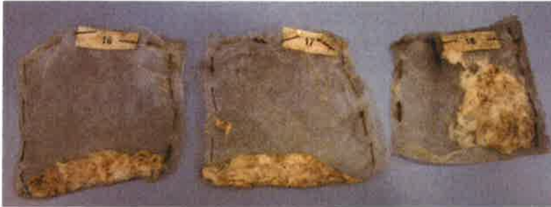
3019 nach 41 Tagen Erdlagerung
